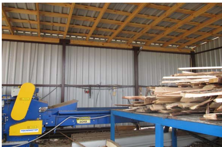
Щепорубильный станок SCORPION EB - 500
